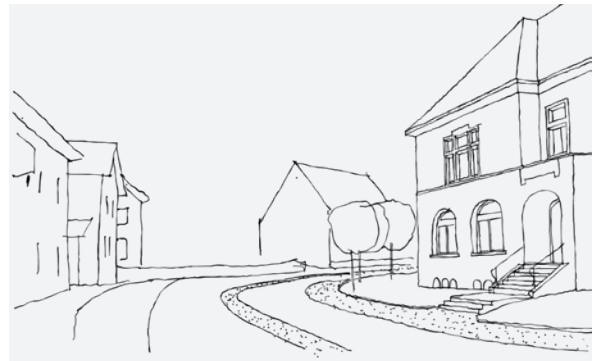
Gemeindehaus, neue Gestaltung der Kantonsstrasse mit Pflasterung (gepunktete Fläche) als Mittelstreifen und Trottoir
